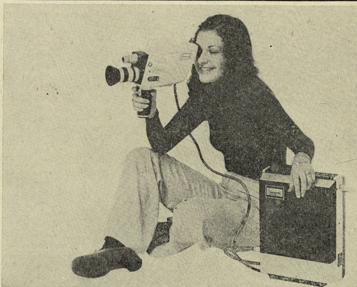
Slika 2. Najmanjša televizijska snemalna garnitura: prenosni kolturni magnetoskop in prenosna TV kamera z vgrajenim mikrofonom (AKAI)
