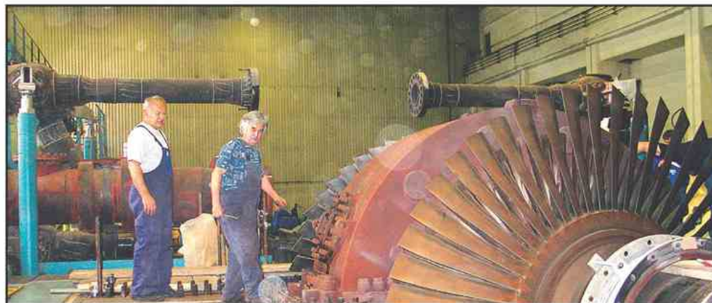
V termoelektrarni Šoštanj veliko pozornosti namenjajo rednemu vzdrževanju in občasnim remontom, saj lahko le tako zagotavljajo zanesljivo obratovanje.
