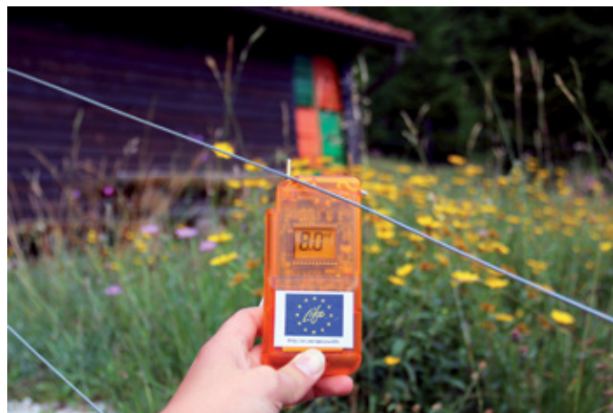
Slika 3: Napetost v elektroograjji merimo s pomočjo voltmetra. Napetost mora biti ves čas nad 5 kV.
