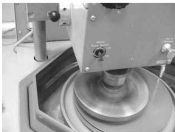
Slika 1: Fotografija nosilca s tremi belimi keramičnimi vzorci (a) in polirne naprave z nosilcem med prvo stopnjo obrabnih preskusov, s predhodnim poliranjem vzorcev na eni od treh polirnih plošč (b). Pri poliranju in obrabnem preskusu se vrtila spodnja plošča in nosilec z vzorci.
