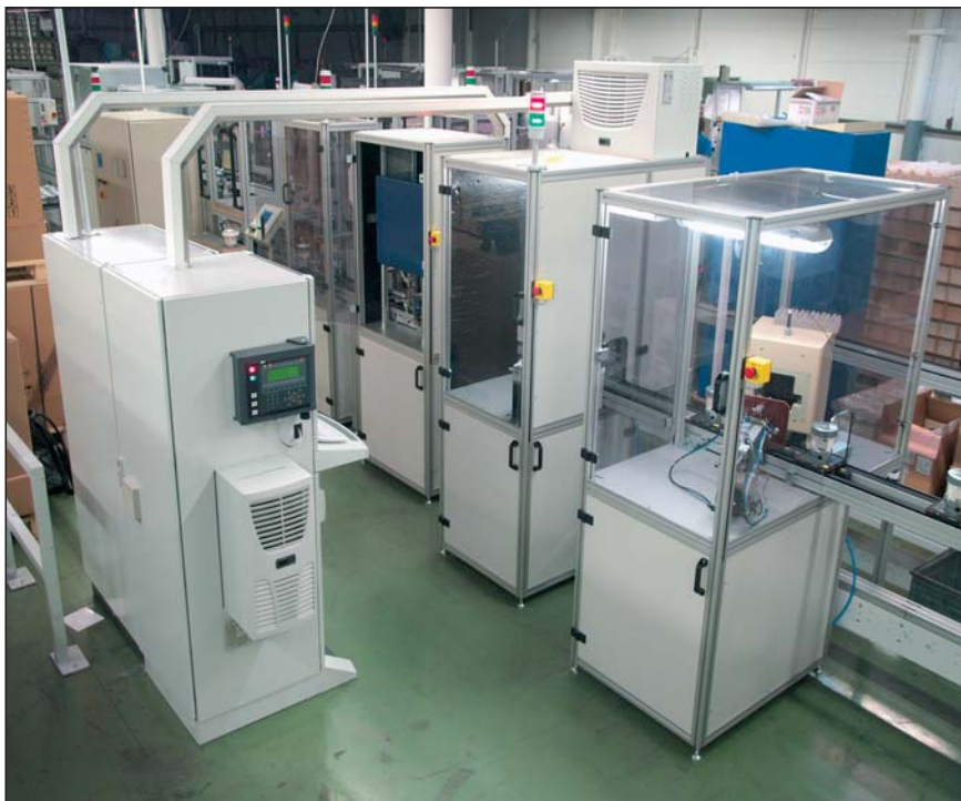
Sistem za avtomatsko končno kontrolo kvalitete sesalnih enot v Domelu, d. d.
