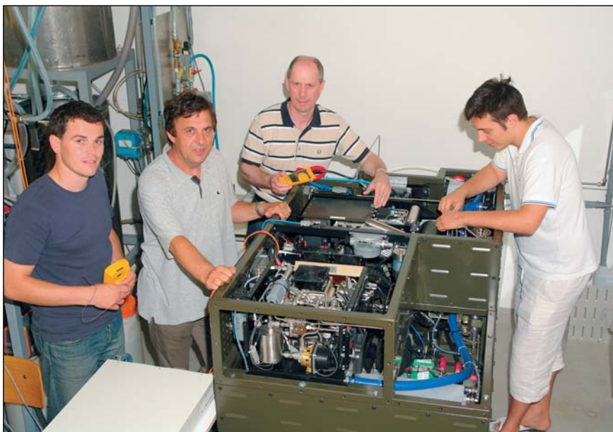
Preizkušanje 7-kilowatnega agregata z gorivnimi celicami
