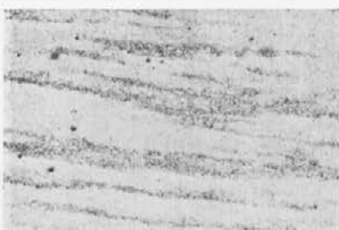
Sl. 7: Mikrostruktura jekla z 0,7% C, 1% Si, 5,5% Cr, 0,7% V, 1,35% Mo in 1,2% W (utop Mo 6) v toplotno obdelanem stanju. Prvi podporni valj sendzimir ogrodja, trdota 55,5 HRC. Povečava 500-krat.
