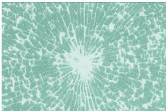
Slika 1: Obnašanje enoplastnega varnostnega stekla pri zlomu
