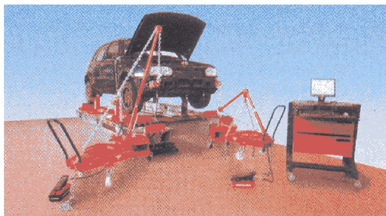
Slika 12: Hidravlična ravnalna naprava z vlečno pripravo po vektorskem principu
