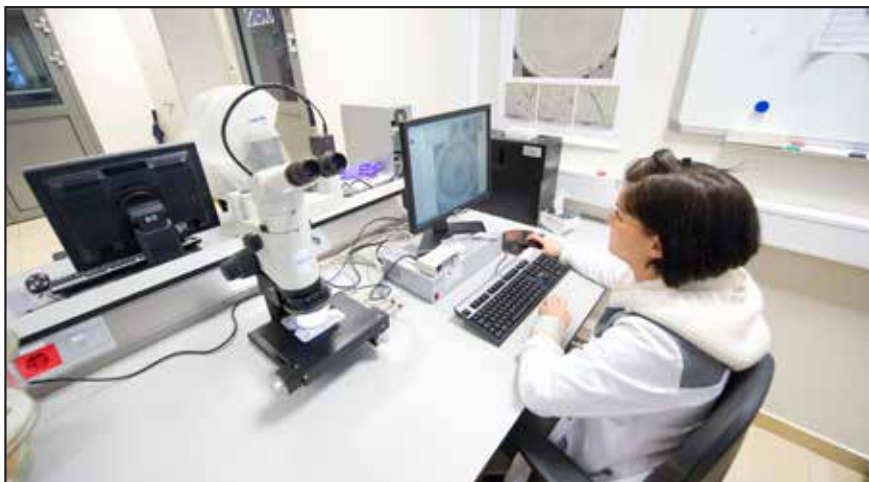
Dnevni utrip v laboratoriju: Analiza kovinskih delcev s stereomikroskopom
