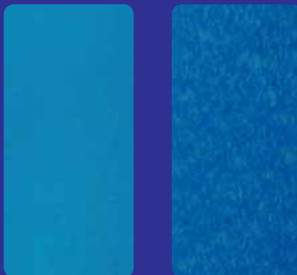
Slika 1: Tiskarska neenakomernost polnih površin (Print Area Mottle).
