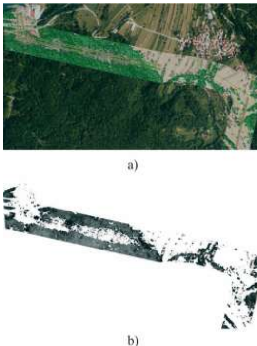
Slika 1: a) Zračni posnetek LiDAR testnega področja, b) Višinski model krošenj visoke vegetacije na trasi.
