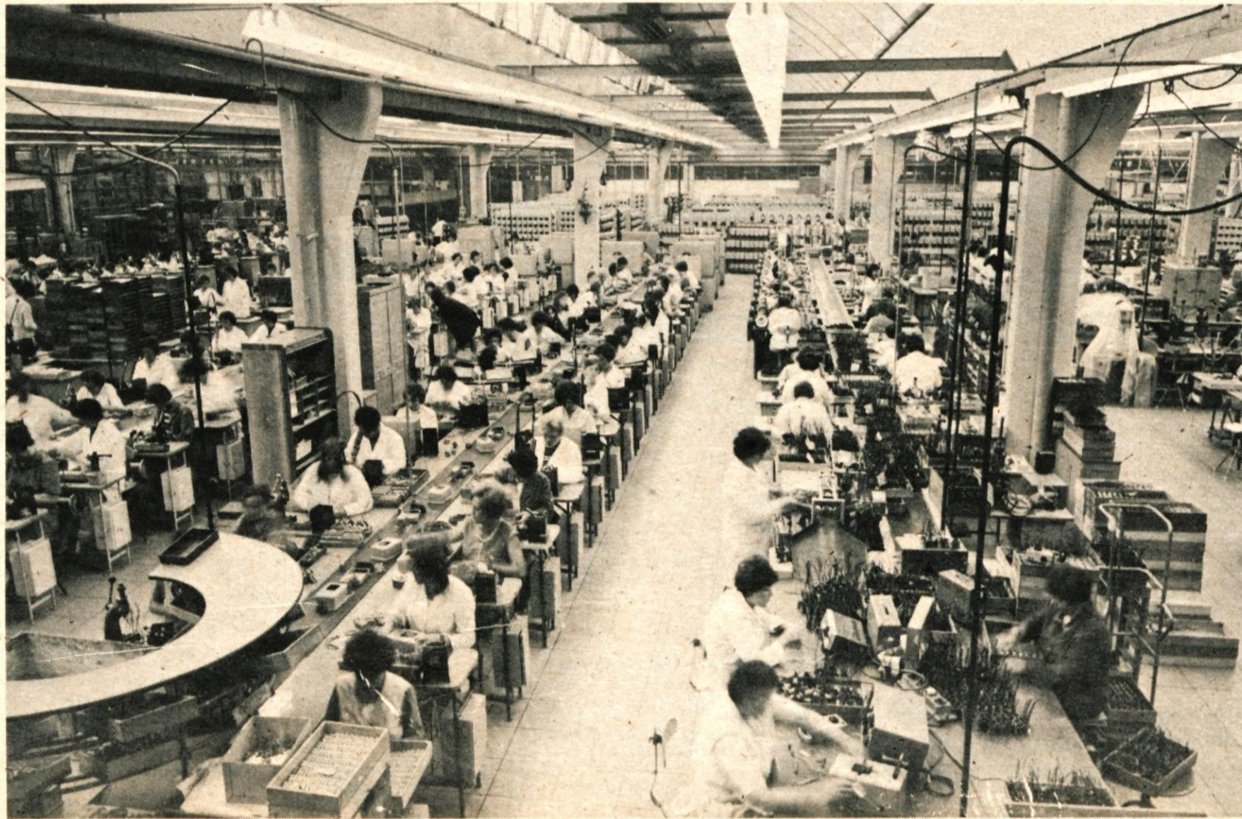
Montaža enofaznih in trofaznih števecv
