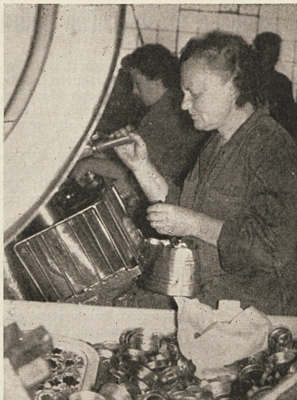
Pravilno zaščiten stroj in orodje omogoča varno in udobno delo Stroj z ročno sprožitvijo in zaščitno napravo ne dopušča, da bi prišlo do nezgode
