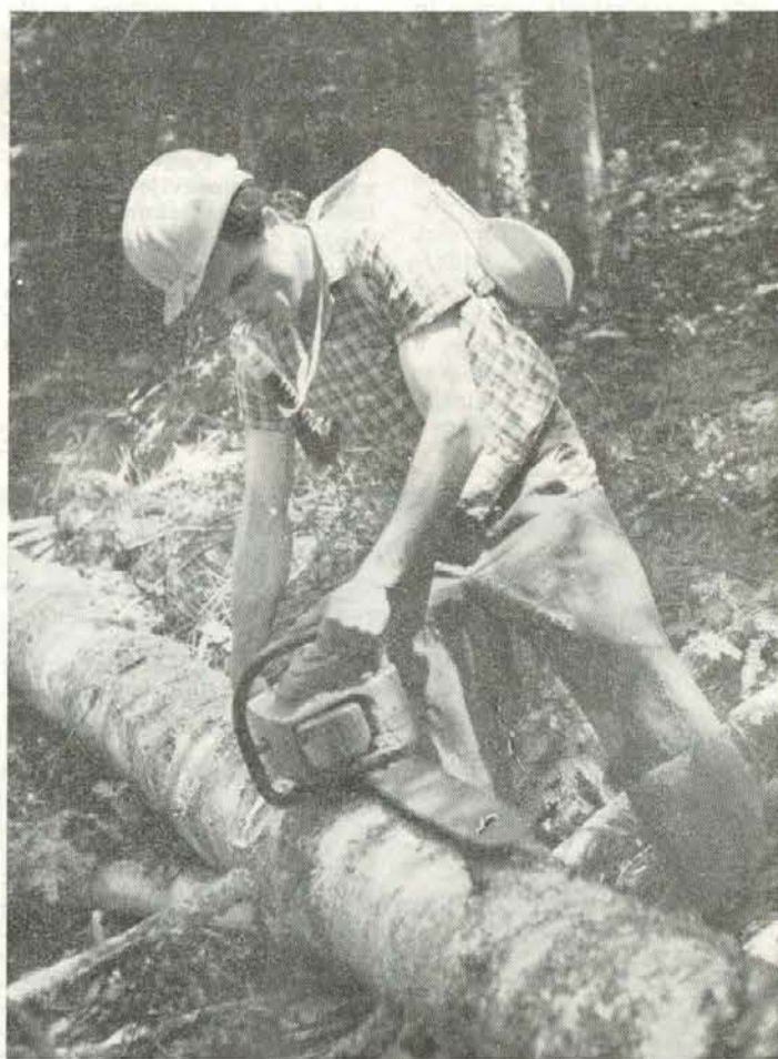
Sekač diha zrak iz atmosfere, izdihava pa skozi posebno merilno pripravo. Ventili in merilna priprava komajda ovirajo normalno dihanje. Iz količine porabljenega kisika izračunamo količino porabljenih kalorij za delo. — Foto: Janko Sušnik
