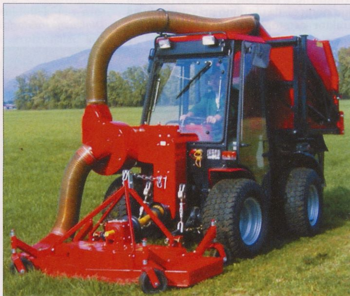
AGT 835 v specialni čelni izvedbi za komunalne namene z rotacijsko kosilnico (hidromehanska izvedba menjalnika)
