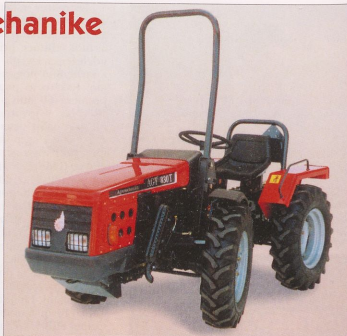
Starejša različica traktorja AGT 830T v togi izvedbi z upravljanjem sprednjih koles, opremljena z varnostnim lokom
