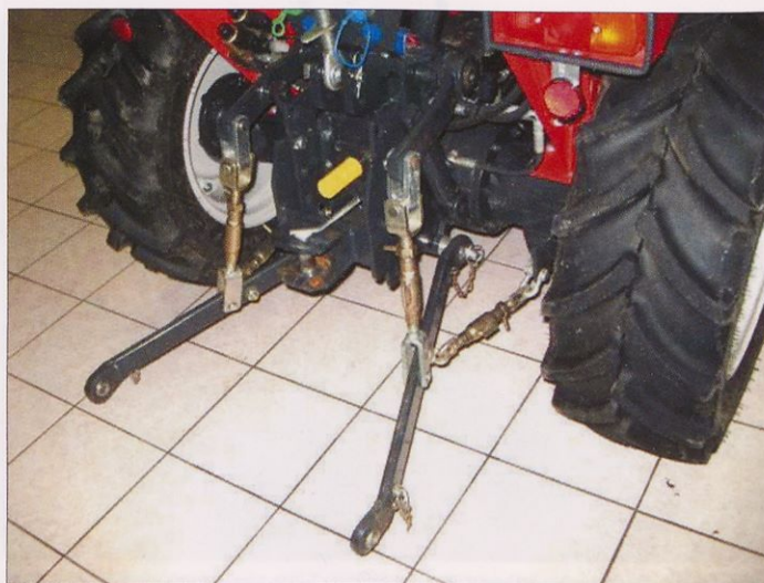
Priključna gred je prekrita s plastično zaščito v rumeni barvi.
