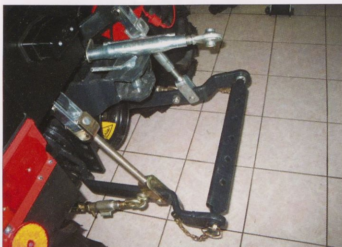
Tritočkovno priključno drogovje hidravličnega dvigala je namenjeno priključevanju delovnih strojev.
