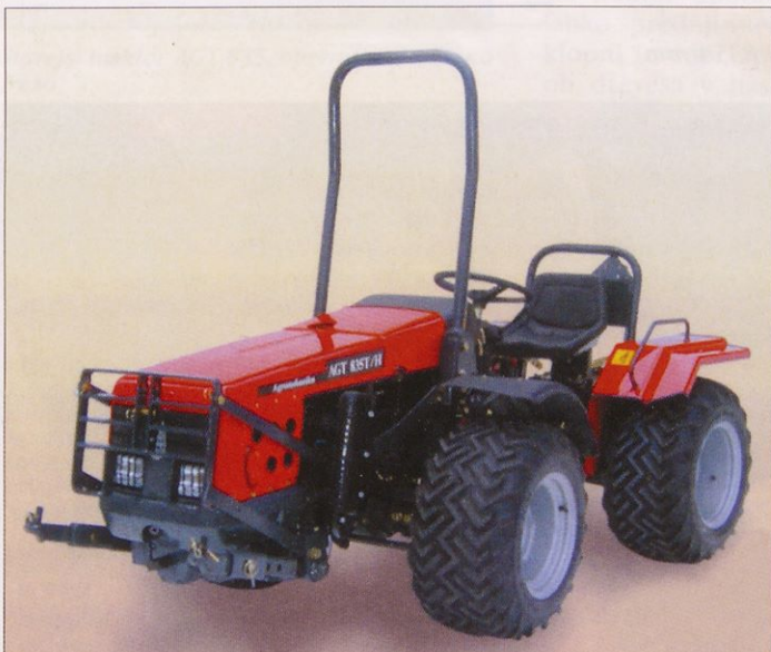
Starejša različica traktorja AGT 835T/H za komunalne namene s hidromehanskim menjalnikom
