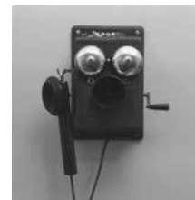
Induktorski stenski telefonski aparat z lesenim ohišjem, inv. št. 800:LJU;0001459, Zbirka Muzeja pošte in telekomunikacij Polhov Gradec, dislocirane enote TMS. (Foto: Jože Seljak.)
