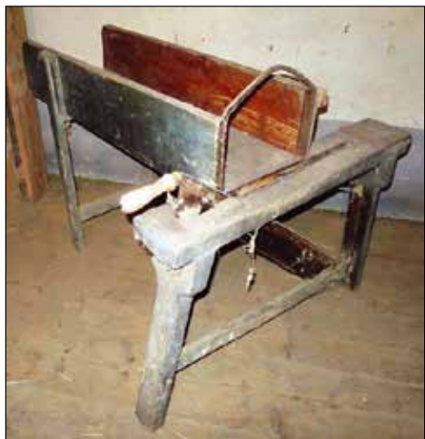
Rezilna truga za rezanje krme za prašiče. Lastnik Jože Potočnik. Foto: Jure Štibelj
