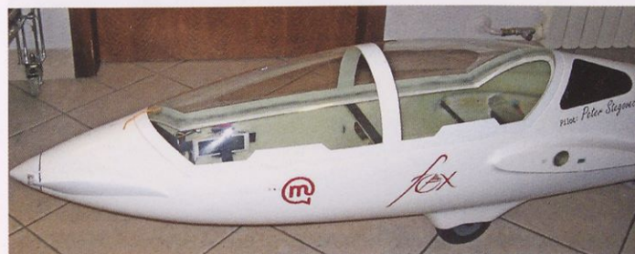
Zasteklitev kabine; v načrtu je tudi izdelava zadnjega okna ter oken na kabini.
