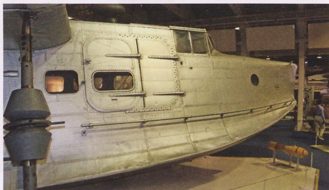
Sprednji del trupa s povečanimi vhodnimi vrati, ki so značilne za civilne predelave stranraerjev po končani vojaški službi.
