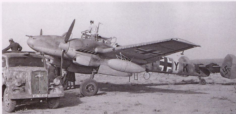
Izvidniška različica Bf 110E z dodatnimi rezervoarji; lepo se vidi filter na vstopniku zraka za višinski kompresor. Vse te dele najdemo v tej Eduardovi izdaji.
