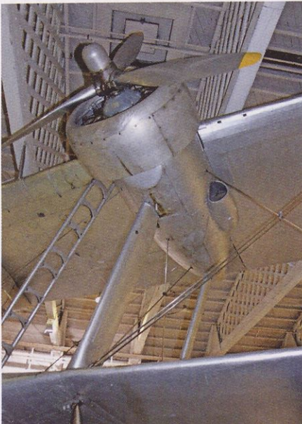
Motorska gondola z ameriškim motorjem wright 1820 cyclone
