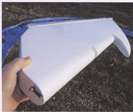
Smerno krmilo, izdelano v sendvič tehniki v kalupih
