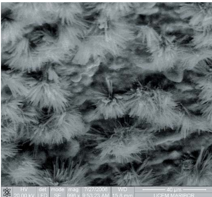
Slika 4 • Mikrostruktura cementnega kamna s pepelom tipa (b), povečana 996-krat
