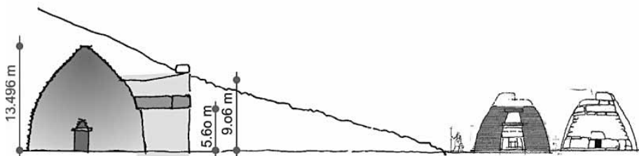
Slika 6: Primerjava Atrejeve zakladnice (imenovane tudi Agamemnonova grobnica) v Mikenah in Navete des Tudons na Menorci: že po velikosti je razlika velika. Naveta je grajena z velikimi, manj obdelanimi kamni, Atrejeva zakladnica je vrhunsko delo strokovnjakov. Medtem ko je za prvo potrebna moč, je pri drugi uporabljena predvsem pamet. Razlike so tudi v predstavitvi objektov, to pa je zagotovo plod okoliščin v času. Velika Atrejeva zakladnica je skrita v hribu in skoraj nevidna, mala naveta pa kaže svojo konstrukcijo, z zidcem funkcionalnega prostora okrog objekta poudarja center in s tem svojo vlogo v življenju družbe.
