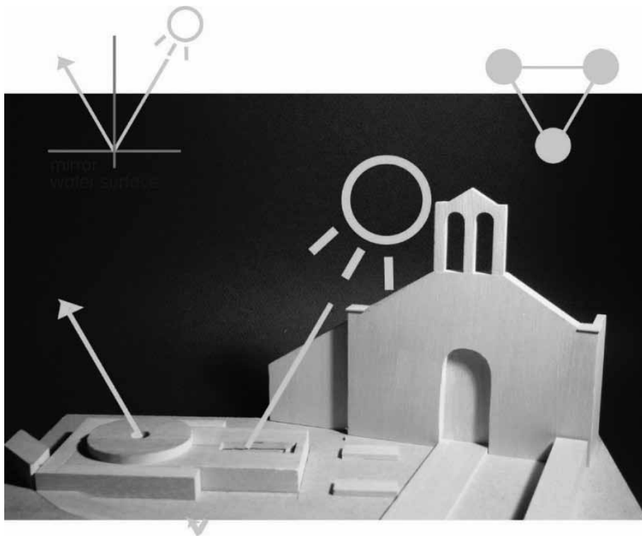
Slika 7: »Pozzo sacro« ali sveti vodnjak Sant'Anastasia stoji pred cerkvico iste svetnice. Na zunaj se kaže le kot okrogla odprtina in pa stopnišče. Sonce posije skozi stopnišče in se na svetničin god odbije od vode ter izstopi skozi odprtino v temenu vodnjaka. Istočasno se žarek pokaže tudi na označenem mestu vodnjakovega oboda, ko posije skozi odprtino. Oboje so si nekdaj razlagali kot čudež. (Juvanec 2014, 86) Teoretično lahko problematiko razložimo s trikotnikom (desno zgoraj), ki v smeri urnega kazalca veže sonce, odboj in čudež.
