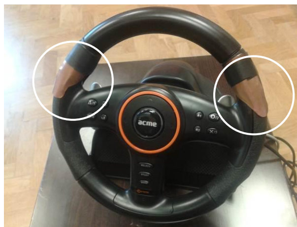
Slika 10: EmoVolan – multisenzorski volan s pedali za igranje računalniške igre, ki je bil poleg drugih senzorjev opremljen tudi z dvema merilnikoma prevodnosti kože (elektrodi obkroženi) [18]
