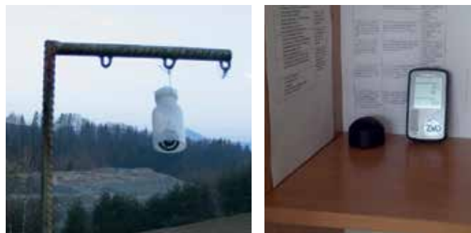
Slika 4: Merjenje koncentracije radona z detektorjem sledi v okolici nekdanjega rudnika Žirovski vrh (levo) in v učilnici v šoli (desno).
