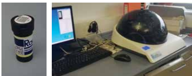
Slika 3: Detektor sledi, ki ga uporabljamo na ZVD (levo), in sistem za štetje sledi (desno).
