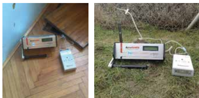
Slika 5: Iskanje virov radona v stavbi (levo) in merjenje koncentracije radona v zemlji (desno)
