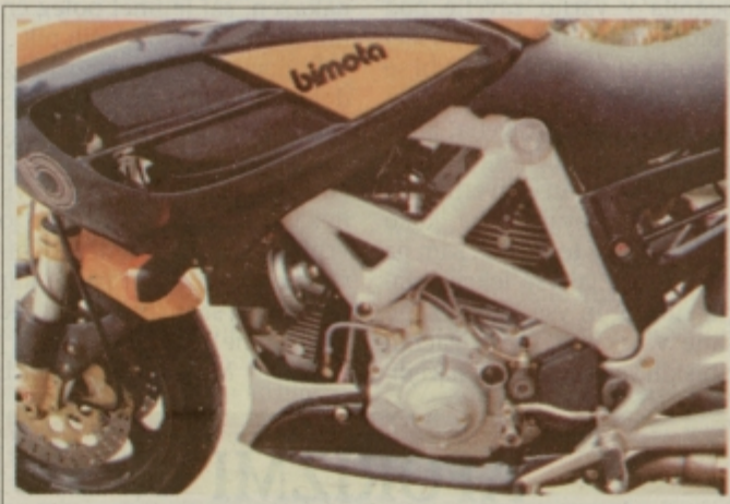
Ducatijev 906-kubični dvovaljnik v okvirju iz ovalnih aluminijastih cevi.
