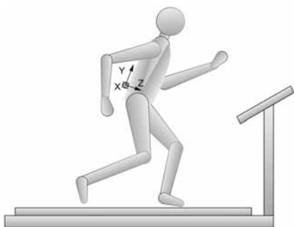
Slika 6: Položaj senzorja na poizkusni osebi med testiranjem. X os v smeri levo-desno, Y os v smeri gor-dol, in Z os v smeri naprej-nazaj.
