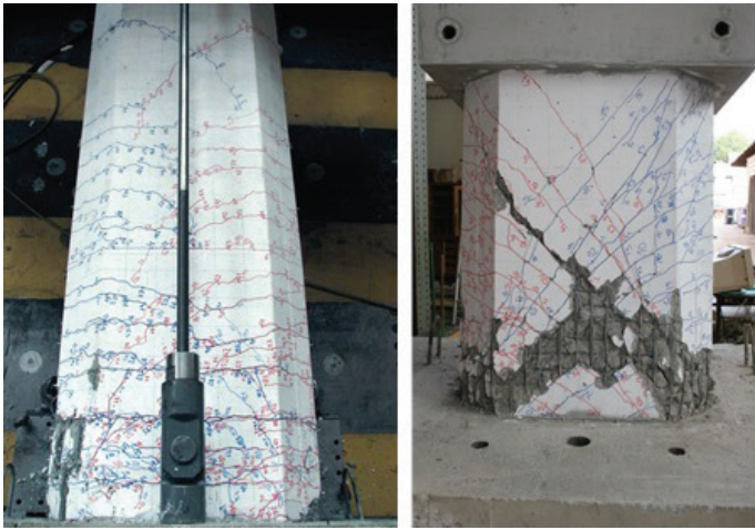
Slika 11. Ciklični testi škatlastih stebrov viadukta Ravbarko-manda v pomanjšanem merilu so narejeni v sodelovanju z ZAG.
