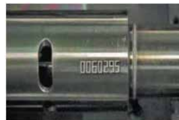
» Slika 9: Palični bat, zvarjen z elektronskim snopom in z vgrajeno kontrolno številko
