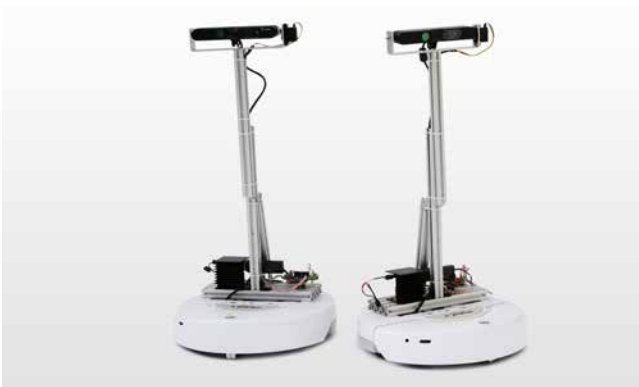
» Dva nizkocenovna robota, opremljena s 3D-računalniškim vidom, sta z RoboEarthovim strojem v oblaku povezana s komercialnim sodobnim centrom podatkov. Robota v funkciji zunanjih izvajalcev uporabljata 3D-preslikavo, spremljata pot in dogovore o ravni storitev (SLAM) ter prepoznavata objekte. ©RoboEarth.org. Foto: Carolina Flores.
