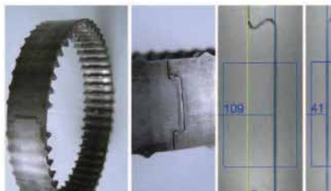
» Slika 10: Pri varjenju menjalnškega prstana so izdelki lahko različno orientirani, varjenje pa bo potekalo po spojnem mestu.
