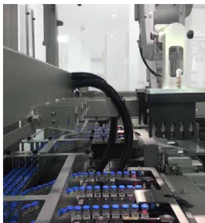
» Robot z vakuumskim oprijemalom skrbi za dvig serije petih stekleničk iz vijakov za pozicioniranje in namestitev za nadaljnje pakiranje.
