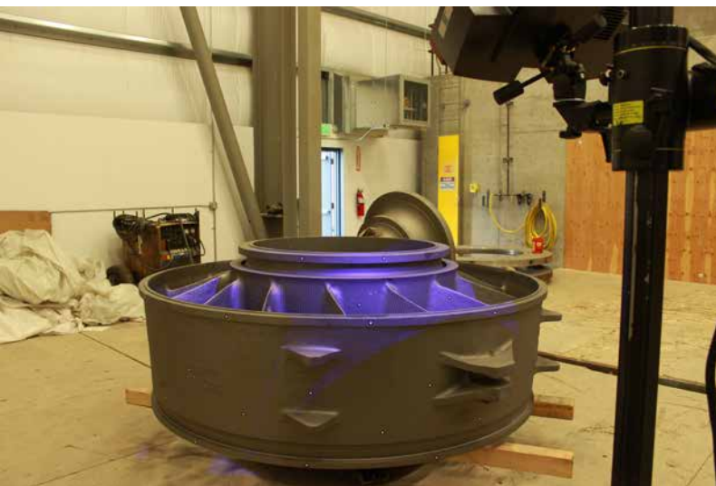
» Slika 3: Projiciranje ozkopasovne modre svetlobe omogoča merjenje neodvisno od osvetlitve okolice in boljši zajem bleščečih površin.
