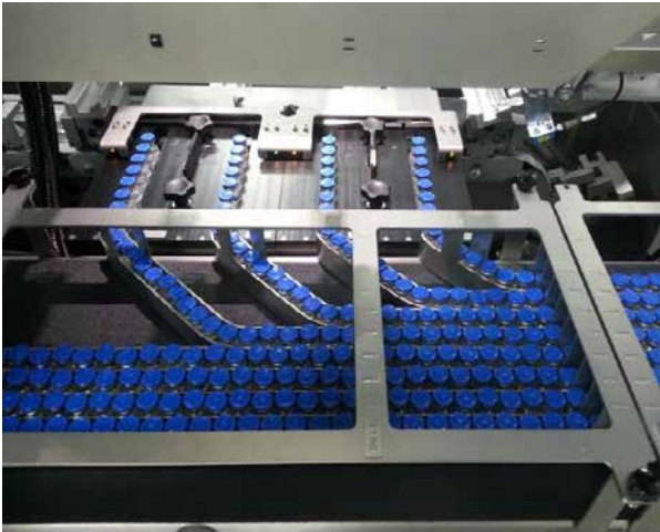
» Transportni trak skrbi za prenos stekleničk na sprejemne postaje, opremljene s pozicijskimi vijaki.
