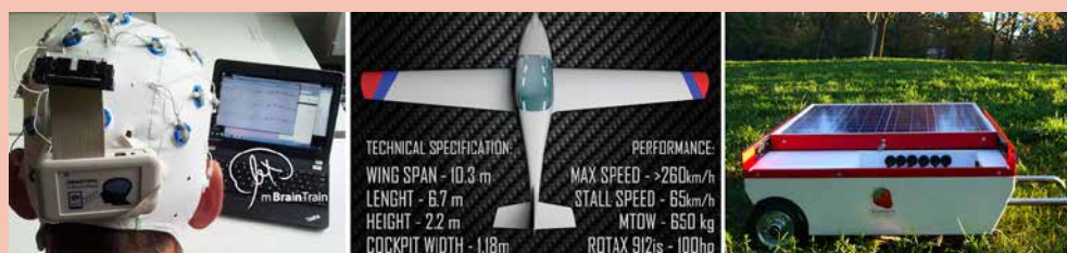
» Predstavitve za obiskovalce: naprava za analizo možganske aktivnosti (levo), lahko letalo iz kompozitnih materialov (v sredini) in prenosni polnilnik Strawberry Mini Rural (desno)
