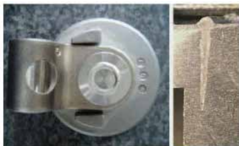
» Slika 4: Glava ventila in makroobrus zvara (desno)
