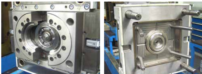
» Orodje za brizganje: na levi - izmetalna stran orodja s premičnim jedrom, na desni brizgalna stran orodja z dolivno pušo in oblikovno ploščo.
