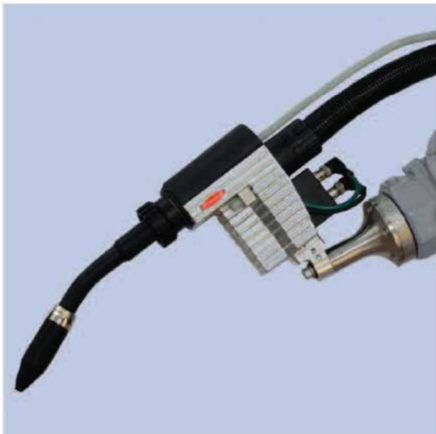
» Novi gorilnik za robotsko CMT-spajkanje
