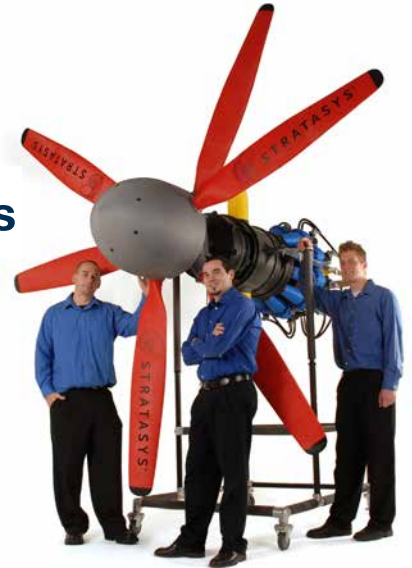
» 3D natisnjen motor s Stratasys tiskalniki družine Fortus
