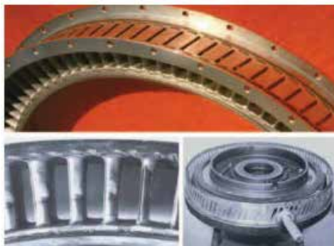
» Slika 12: Prstan turbinskih lopatic: zgoraj sestavljeni stator, levo detajl sestava zvarjenih lopatic in desno celoten sestav
