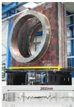
» Slika 11: Oscilacijo elektronskega snopa zaradi zaostalih magnetnih polj lahko zgladimo z računalniško korekcijo.
