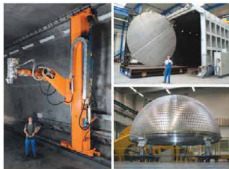
» Slika 7: Največja naprava za varjenje z elektronskim snopom: robotsko varjenje rezervoarja rakete Ariane iz dveh 70 mm debelih aluminijastih plošč (pozneje preoblikovano in obdelano)
