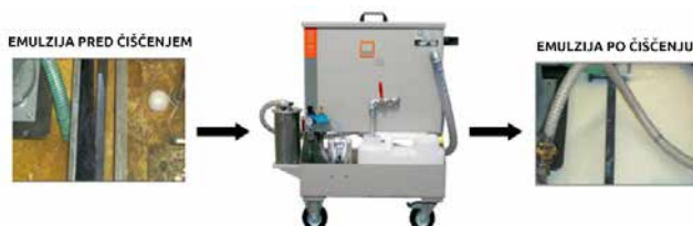
» Slika 2: Večnamenska naprava za čiščenje in sterilizacijo emulzije 9
