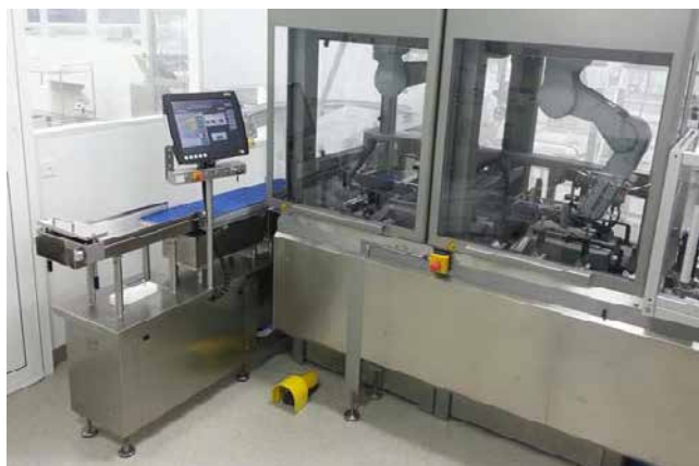
» Konkretna rešitev je sestavljena iz dveh MRT-celic z vgrajenima stropnima robotoma in transportnim trakom, gnanim s servopogonom.
