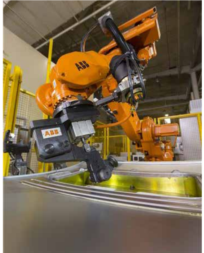
» ABB-jeva rešitev Roller Hemming v tovarni Changan-Ford
