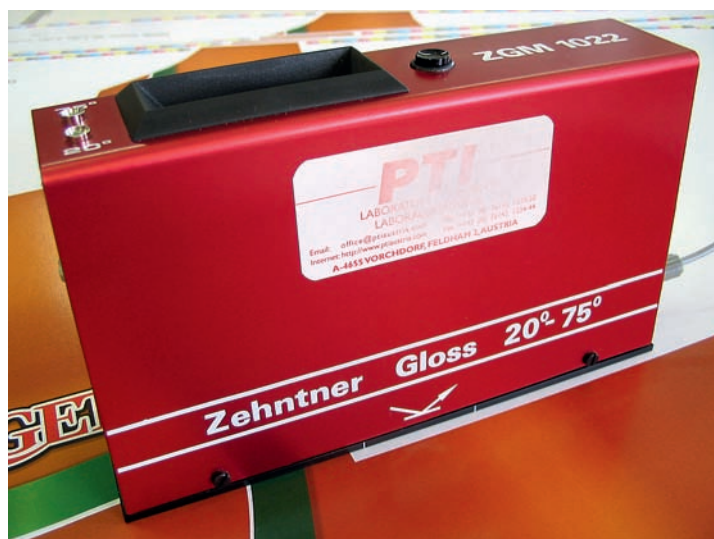
Slika 6. Merilnik sijaja Zehntner ZGM 1022.
