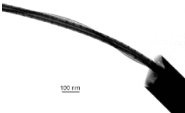
Slika 7: Prve anorganske nanocevk v Ljubljani: par nanocev \text{WS}_2 raste iz notranjosti mikrocevi. Ožja cev s premerom 18 nm se dovolj enakomerno ovija okoli debelejšje cevk premera 40 nm. Druženje obeh cevk lahko razložimo s tvorbo vmesnih ploskev med kristalnima mrežama obeh cevk. Stik med cevkama je možen le v točkah, kjer sta urejenost in orientacija sten skladna s prostorsko grupo P6_3/mmc (foto: Maja Remškar).
