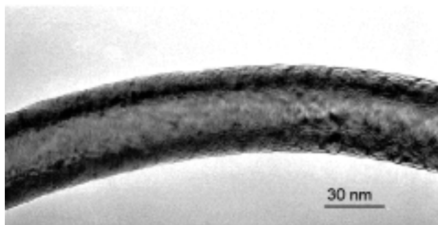
Slika 6: Visokonapetostne kepaste napake in luščenje tanke plasti površine nanocevke, nastale zaradi dodatnega tlaka ob njenem upogibanju (foto: Maja Remškar)
