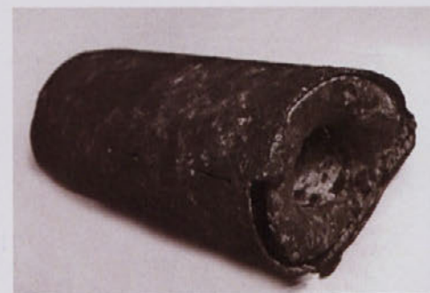
ZADNJI DEL RAKETE RP 3. LEPO SE VIDIJO ZAREZE, V KATERE SO BILA MONITORIRANA KRILCA RAKETE. (FOTO: ARHIV L. TROŠT)
