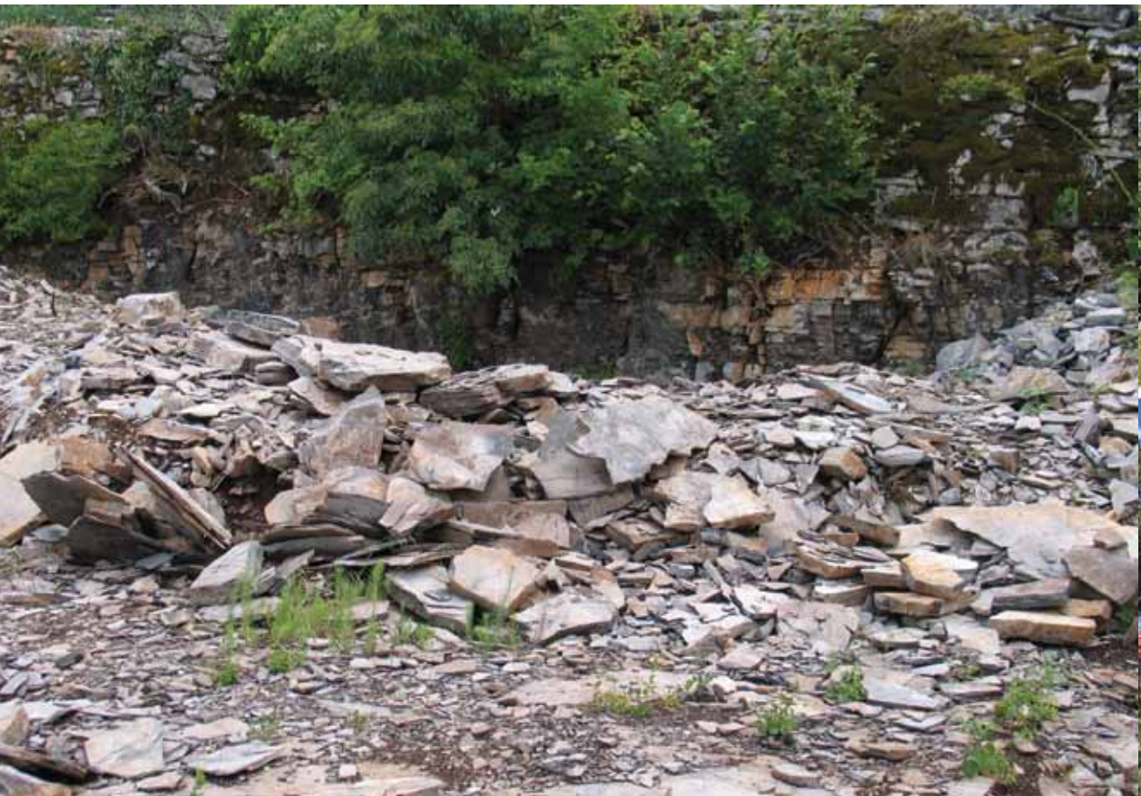
Slika 2: Opušteni površinski kop Komenskega ploščatega apnenca v Gabrovici/Coljavi na Krasu, ki so ga uporabljali za pokrivanje streh in tlakovanje. Foto: Bogdan Jurkovšek.
