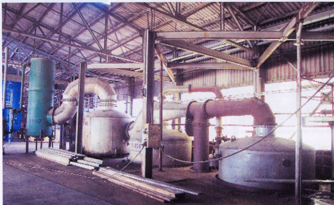
Moja prva naloga po končanem pripravniškem izpitu - vakuumski uparjalnik, ki že osmo leto zapuščen sameva, sedaj pa predaja prostor novim filtrom za Filtracijo črne raztopine.
