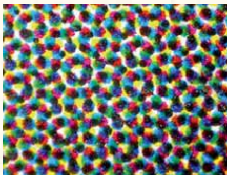
Slika 4: Rozete pri rastru linijature 175 lpi, levo konvencionalni raster – Esko Paragon, desno raster Esko Concentric.
