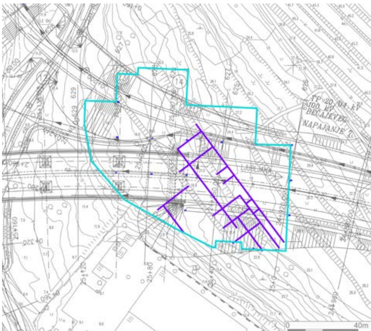
10 Interpretacija rezultatov geoelektričnega kartiranja. Linije predstavljajo usmerjene visokoupornostne anomalije zaradi zidov rimske vile in obdelovalnih teras.
