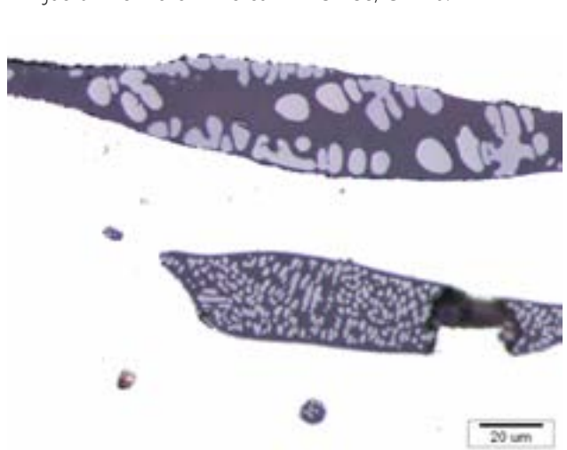
465 Mikroskopski posnetek deformiranega nekovinskega vključka v kovinskem vzorcu PN KOV 58, G1120.
