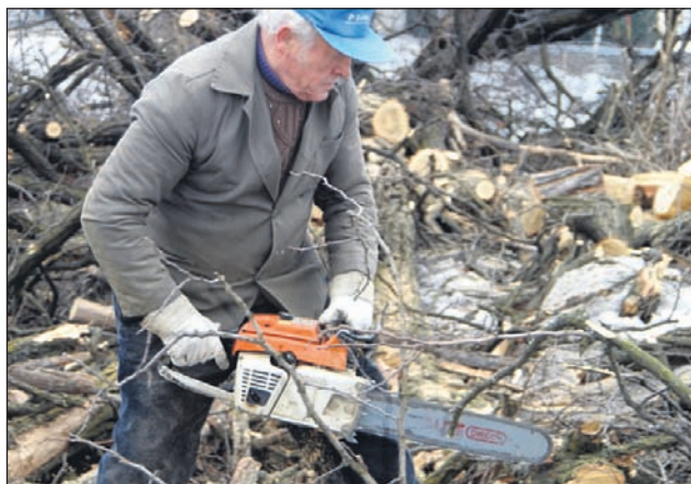
Sanacija gozda po žledu je nevarna, saj gre za polomljena debela in nagnjena drevesa, v katerih so lesna vlakna še vedno napeta.
