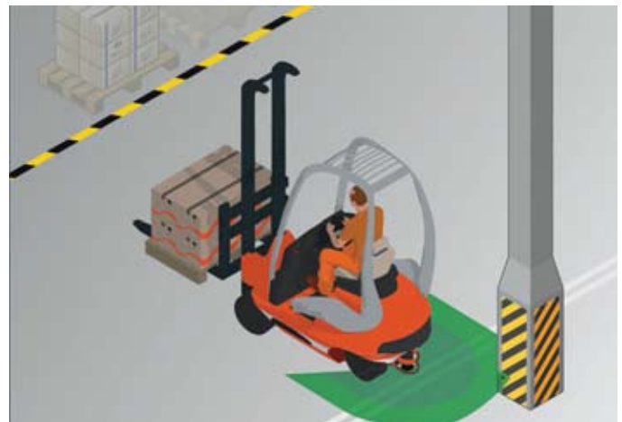
Slika 2: Varovanje pri vzvratni vožnji
