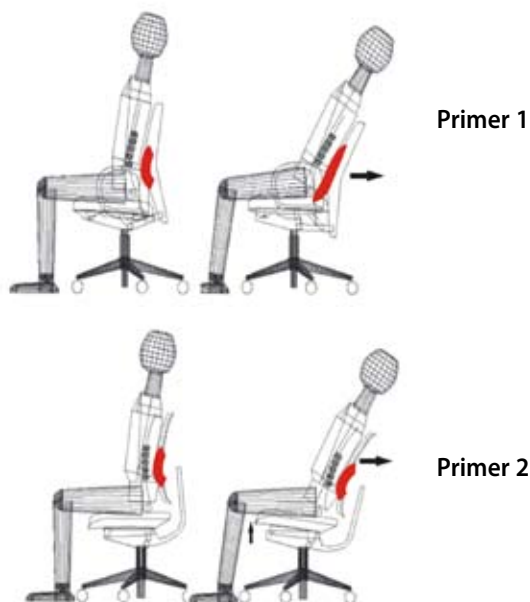
Slika 11: Žični model na dveh različnih pisarniških stolih in vpliv nagiba sedala na lordotični položaj hrbtenice (Lengsfeld et al) 16
