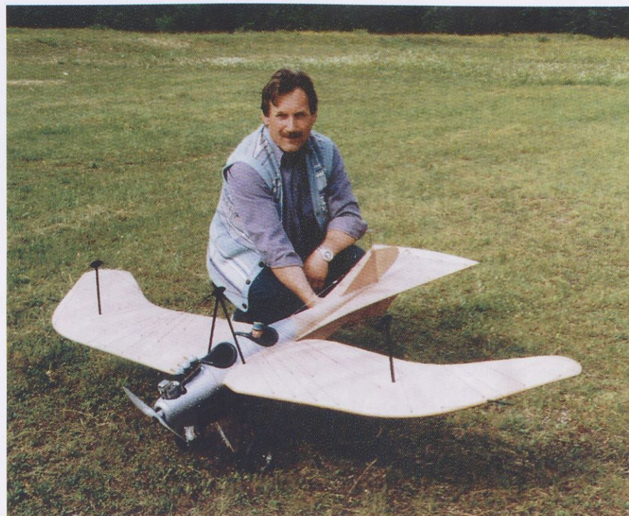
Johann Ogris je nastopil z dvema maketama letal: etrich taube, na sliki (razpetina 2200 mm, 4-taktni motor O. S. max 8 cm 3 , masa 2,9 kg) in Blackburn.
