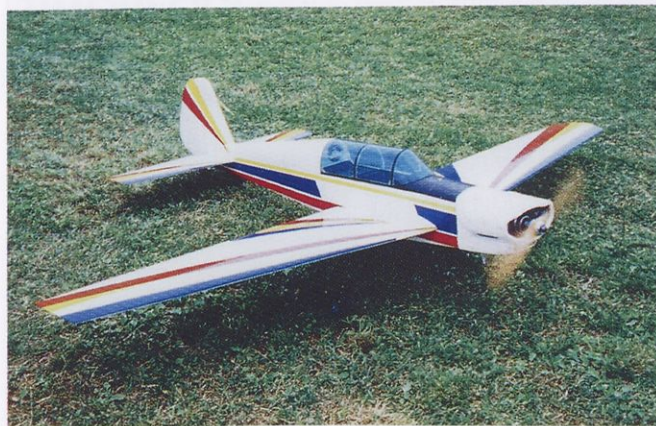
Maketo letala dalotel z razpetino kril 2500 mm, motorjem 38 cm 3 in maso 9 kg je v samogradnji izdelal Rado Bertoki.
