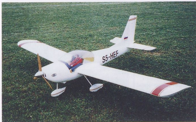
Dr. Rafael Cajhen se je predstavil z maketo letala swiss trainer. Model ima razpetino kril 3400 mm, tehta 13,5 kg, poganja pa ga motor Titan ZG 62 cm 3 .
