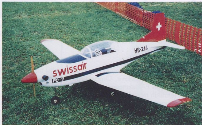
Maketo letala PC-7 z razpetino kril 2500 mm in maso 16 kg je Rado Bertoki gradil cela tri leta. Vanjo je vgradil motor Atlas 45 cm 3 .
