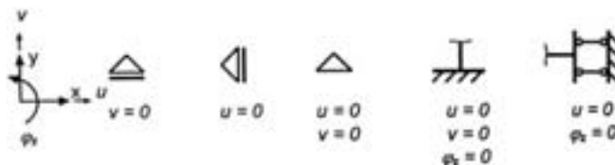
Slika 5: Shematski prikaz najpogosteje uporabljenih tipov podpor ravninskih konstrukcij. Schematic representation of the most often used types of supports in planar structures.
