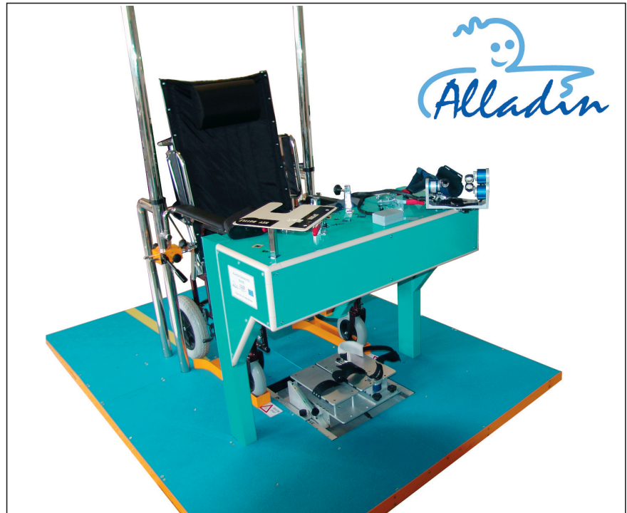
Izometrično merilno okolje za osebe po kapi v projektu Alladin (FP6 EU)
