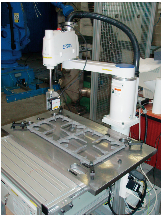
Merilna celica z robotom Epson in laserskim senzorjem za predmete kompleksne oblike
