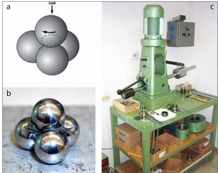
Slika 3. a), b) Princip meritve točke zavaritve, c) štirikrogelni aparat Hansa
