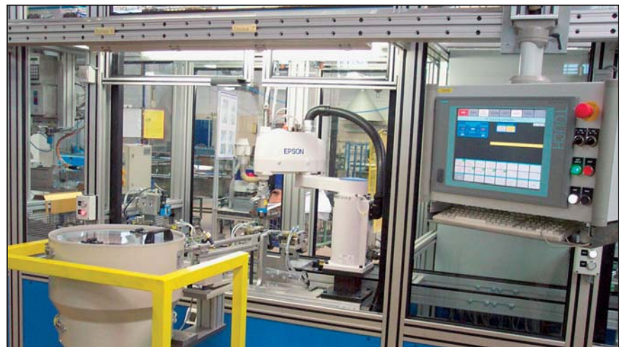
Slika 4. Montaža keramičnih elementov
