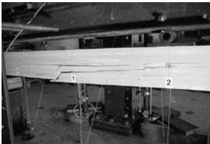
Slika 5: Tipična porušitev PLLLN preizkušancev iz običajne kvalitete smrekovega lesa
