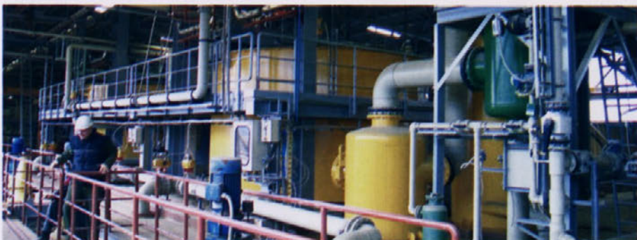
Na mestu starih kristalizerjev stojita dve novi liniji vakuumskega hlajenja ter kadi za napajanje hidrolizerjev
