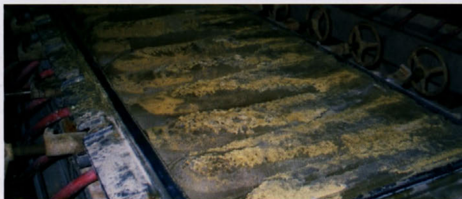
Filter Scheibler zapolnjen z blatom, ki je ostalo v njem po filtraciji
