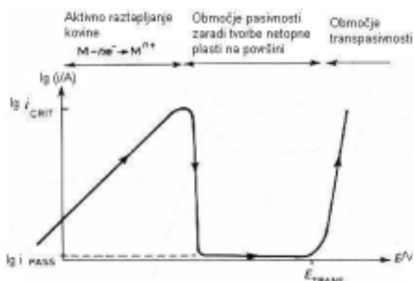
Slika 6: Krivulja Lg |i| - E za kovino, ki kaže klasično pasivnost
