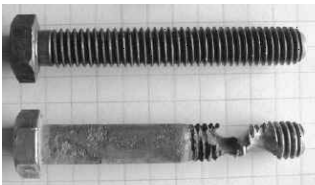
Slika 12: Prikaz korozije v špranji (4)
