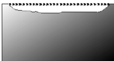
Slika 7: Prikaz enakomerne korozije (4)
