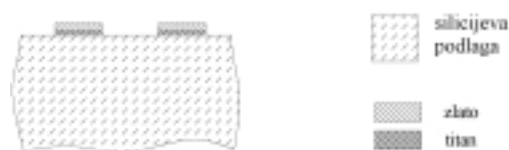
Slika 12: Shema prereza ploščice po dvigovanju; na površini ostane tanek vodnik iz plasti titana in zlata
