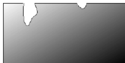
Slika 9: Prikaz jamičaste korozije (4)
