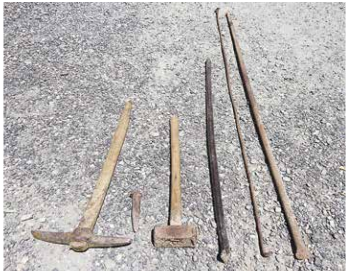
Orodje za delo v kamnolomu: kramp, kajla z macolo, pajser, žlica za čiščenje lukenj, štanga za vrtnje (foto: D. Krpič)
