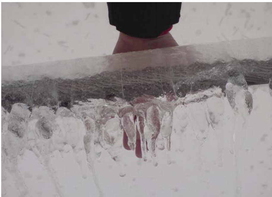
Slika 7 • Amorfn žled na vodniku AlFe 490/65 mm 2 , 2. februar 2014
