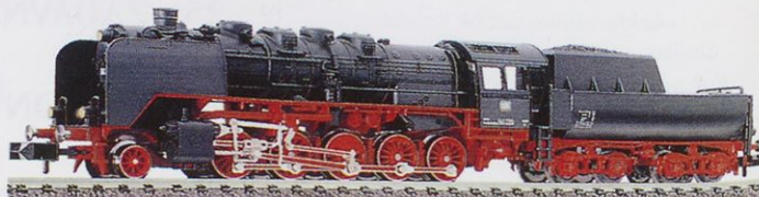
Lokomotiva DB 50 s petimi pogonskimi osmi je služila za težki tovorni promet. Zaradi velike moči je tudi s težkimi tovori dosegala velike hitrosti (Fleischmann).
