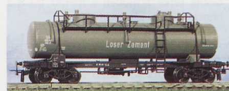
Dolg tovorni vagon cisterna služi za prevoz cementa (Klein Modellbahn).
