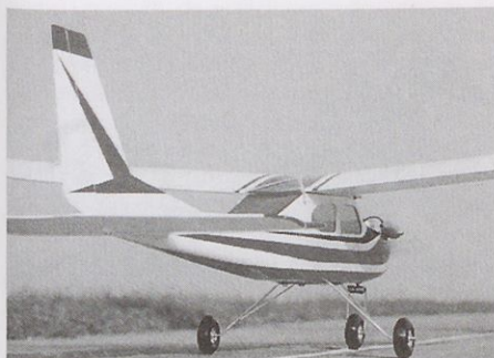
Slika 2. Robbejev charter "živi" že četrto stoletje. Poskusite še z električnim pogonom. Dobra izbira je motor Marx GT-300/7, 12 celic RC2000 in vijak od 8 x 6 do 9 x 4. Model bo dosegel hitrost od 60 do 80 km/h. Izbran režim motorja je pri 12.000 vrtljajih na minuto in porabi okoli 20 A, kar omogoča šest minut delovanja motorja s polno močjo oziroma desetminutni polet.
