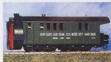
Zanimiv je model vagona za odstranjevanje snega s proge s centrifugalnim rotorjem. Ker vozilo ni imelo lastnega pogona – para je obračala le rotor – so ga priključili pred lokomotivo. V Nemčiji, Švici in Avstriji so ta "odstranjevalec snega" uporabljali do osemdesetih let (Klein Modellbahn).
