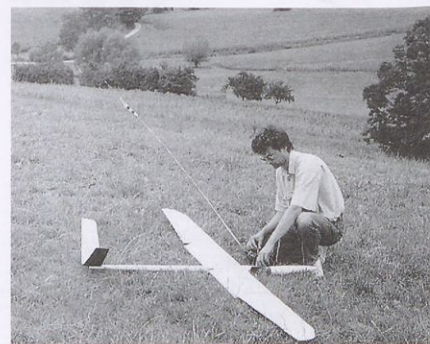
Slika 11. Pred štartom moramo vedno preveriti delovanje komand in drugih sistemov na modelu.
