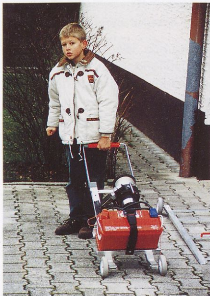
Slika 3. Breme na podstavku je razporejeno tako, da so težji predmeti pomaknjeni blizu osi koles, ročaj pa daleč proč. Na ta način brez navora prevažam vitel do zelenega mesta na poligonu.
