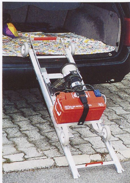
Slika 4. Podstavek z vitlom je zataknjen za zgornjo prečko mostu in pripravljen, da ga potisnem v prtljažni prostor avtomobila. Podnožje mostu je razcepljeno, da se dobro vsidra v tla. Zdrs bi povzročil hude poškodbe opreme.
