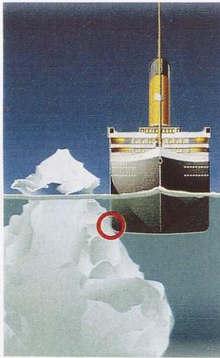
Ledena gora je ladjo popraskala 6 m globoko po sprednjem delu trebuha. Dotik je bil tako silovit, da je kot za šalo prerezal 25 mm debele jeklene ploščice, ki so obdajale ladjo.
