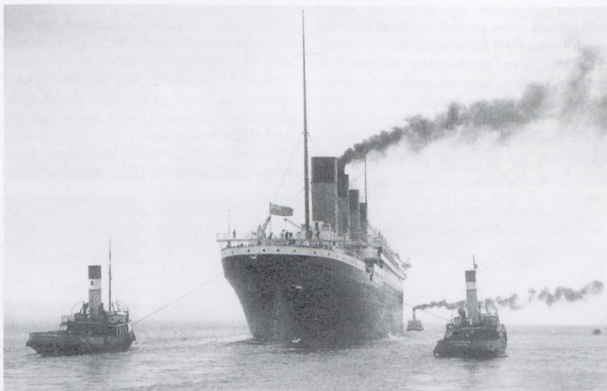
Titanik je bil resda hiter, zato pa zelo nekreten. V pristanišču so ga morali voditi vlačilci (remorkerji), na odprtem morju pa je le počasi zavijal. Ko se je 400 m pred njim pojavila ledena gora, se ji pri hitrosti 21 vozlov ni mogel več izogniti. Za ustavljanje je namreč rabil kar 1500 m dolgo pot.
