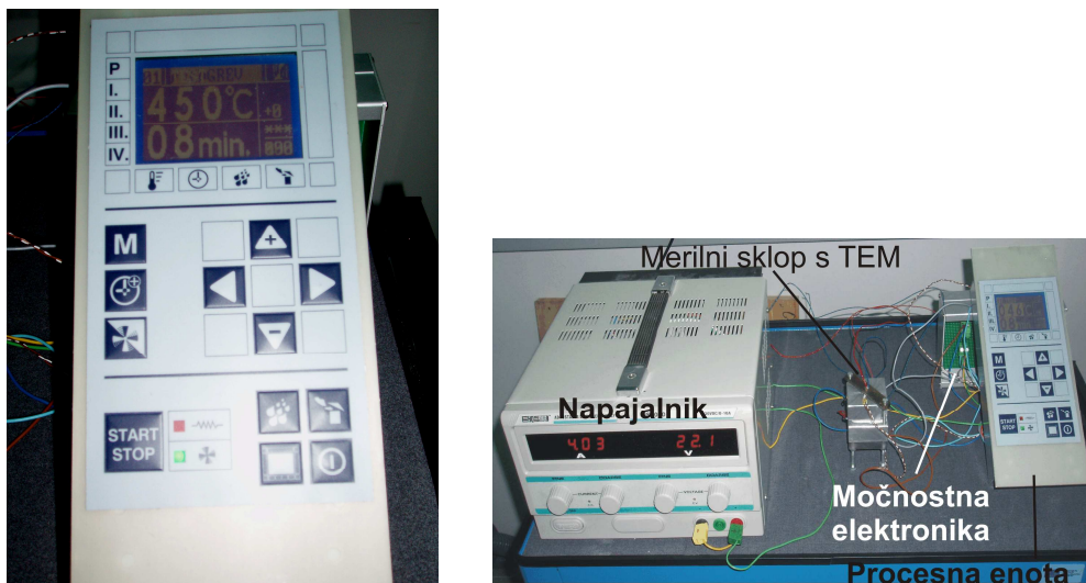
Sliki 58. Krmilnik v delovnem okolju: na levi sliki je prikazana procesna enota, na desni pa celoten testni sistem, opisan v poglavju 5.1
