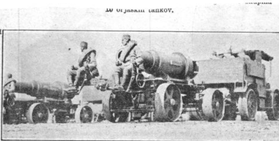
Ogromni dalekometni topovi so montirani na avtomobilih, ki omogočajo njihovo hitro prevažanje. Ta najtežja artiljerija je bila v defileju pozdravljena s posebnim zadoščenjem.
