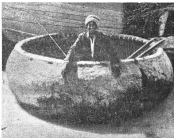
Gufa, najstarejša vozila na svetu, še danes v rabi na Tigrisu. Okrogel koš (3 m v premeru), zunaj namazan z mešanico kamenega olja in ilovice.
