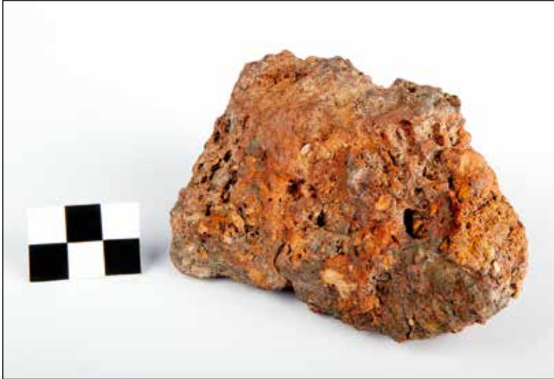
Primer težke žlindre. Žlindra je stranski produkt pri pridobivanju železa. Foto: Andrej Bogataj
